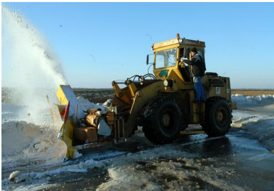
Утоваривач са додатном опремом- Ролба, снегобацач ЈКП „Пут“
